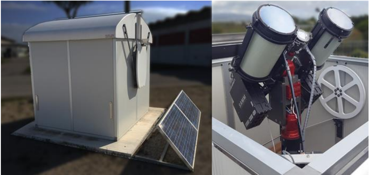
Figura 4. Prototipo del telescopio SAMM con el domo que lo aloja (izquierda) y el montaje que incluye los componentes opto-mecánicos (derecha), ubicado en las instalaciones de la empresa Avalon Instruments, cerca de Roma (Italia).
